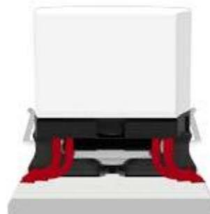
Die Abbildung zeigt das grundlegende Prinzip des Spacers: zwischen Schuhsohle und Ski wird ein Kontakt hergestellt, um die vertikalen und torsionalen Lasten direkt zu übertragen.
