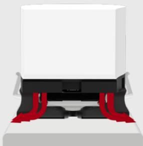
La figura mostra il principio base dello spacer: creare un contatto tra suola scarpa e sci per trasferire direttamente i carichi verticali e torsionali.
