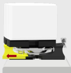
Lo spacer è fornito di 2 "pads" elastici scorrevoli. Queste "torrette" garantiscono il mantenimento del valore di sgancio laterale anche quando il sistema è sotto carico (salti o compressioni).
